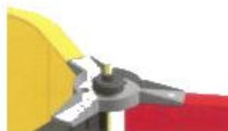
Nehmen Sie die Regenhaube (M) und drücken Sie diese über das massive Rohr an der Oberseite, bis es auf dem Keil ruht.
