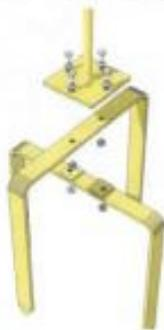
Schrauben Sie die 2 Sets der Bodenstecker (E) mithilfe der Bolzen, Ringe und Muttern an die Basisplatte. (J, K & L)
