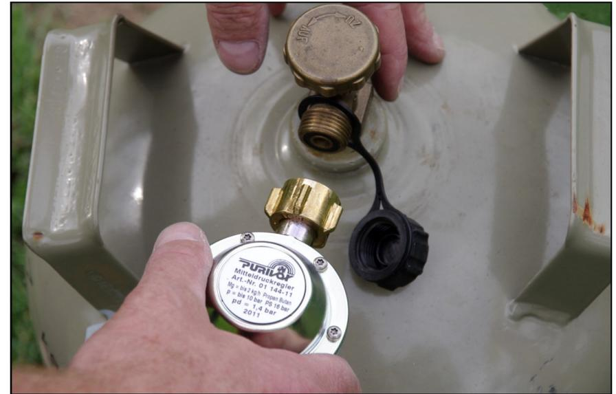
Verbinden sie den KLF Regler (101560) mit der Propan Gas Flasche. Benutzen sie gegebenenfalls eine Zange um den Regler festzuziehen.
