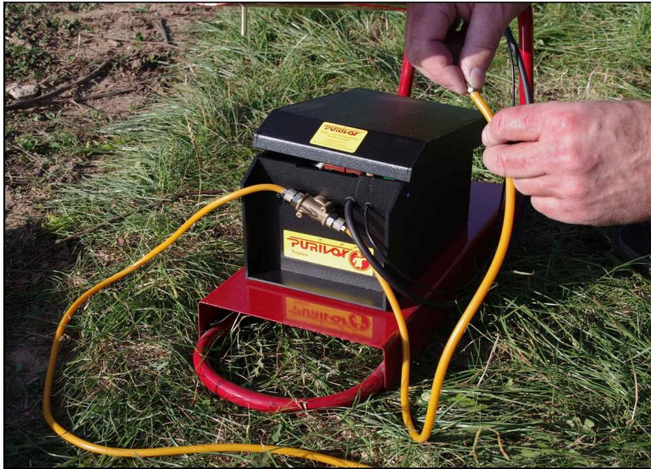
Ziehen sie nun an dem Gasschlauch (GS-2), welcher von der Elektronikeinheit wegführt (Magnetventilseite Pfeilspitze), die eingesteckte Propan-Gas Düse ab.
