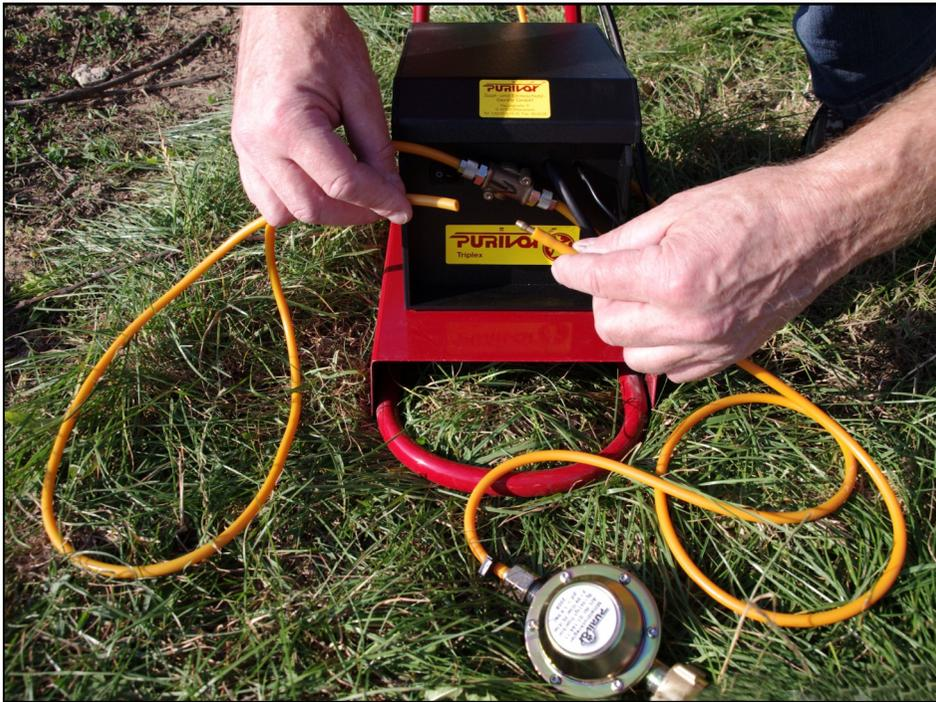
Verbinden sie nun den Gasschlauch (GS-1) welcher von der Elektronikeinheit wegführt (Magnetventilseite Pfeilende), mit der Schlauchtülle des Gas-Schlauches vom KLF Reglers (101560).
