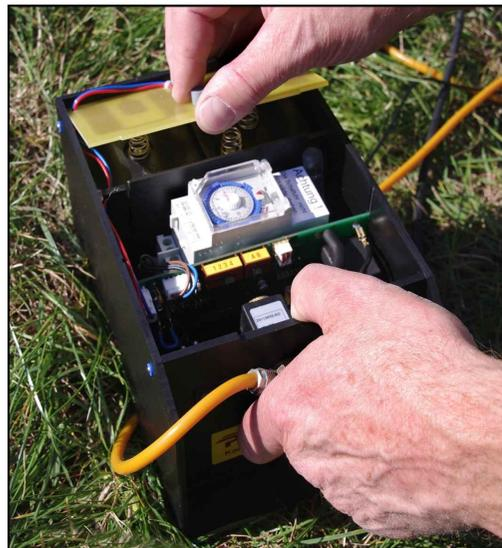
Öffnen sie den Deckel der Elektronikeinheit (108510) und stellen sicher, dass der Papierstreifen unter der Batteriekontaktplatte entfernt ist.
