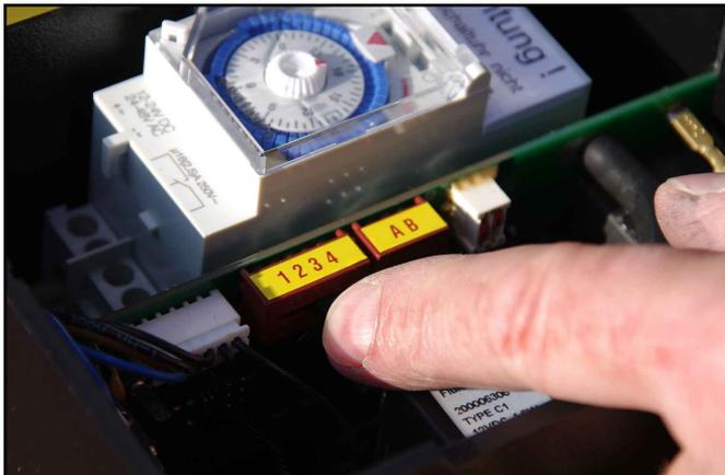
**Beginnen sie deshalb möglichst mit einer Einstellung, bei der es seltener knallt. Erst wenn der Vogelanflug/Wilddruck stärker wird, sollten Sie durch Wahl einer niedrigen Schalterstellung (z. B. von „3“ nach „2“) die Zeitabstände zwischen den Tripletten verkürzen.**
