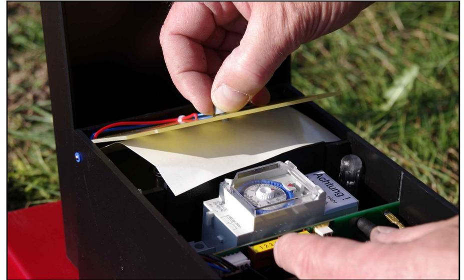
Öffnen sie den Deckel der Elektronikeinheit (108510). Heben sie die Batteriekontaktplatte an und entfernen sie den Papierstreifen um den Kontakt mit den Batterien herzustellen. Drücken sie die Batteriekontaktplatte danach wieder zurück, sodass sie geschlossen ist.
