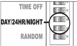
Die beiden Schalter für die Beschallung befinden sich genau unter den „TIME-OFF“ Schaltern im oberen Schaltbereich. Der Nachtmodus läuft während der Nacht, der Tagmodus während des Tages. Jedoch ist die Fotozelle, welche Tageslicht
