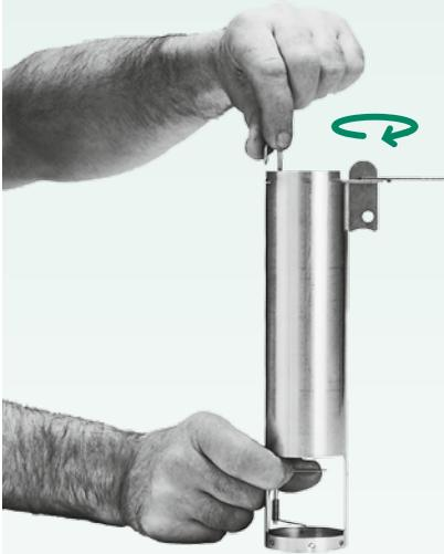
Die Wippe ist in Sperrposition (siehe Seite 6). Die beiden Auslöser werden nacheinander in der richtigen Position festgehalten. Gleichzeitig wird die Auslösestange am Haken gefasst und ausschliesslich im Uhrzeigersinn in die richtige Position gedreht, bis Haken und Auslöser parallel zur Wippe ausgerichtet sind.
