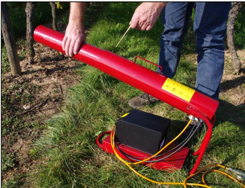
Schieben sie das Schallrohr in das Schußgestell ein und sichern es mit dem Feststellstift (130012). Siehe nächste Seite für Schallrohr-Einstellungen.
