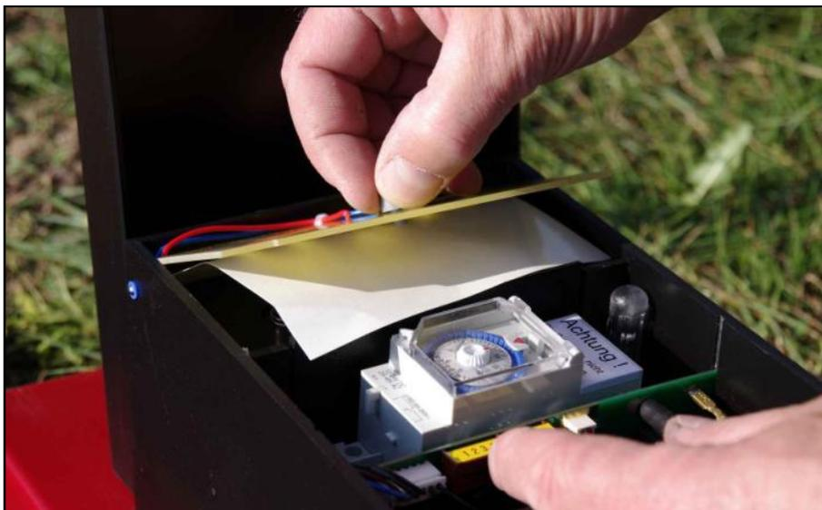
Ouvrez le couvercle de l'unité électronique (108510). Soulevez la plaque de contact pour pile et retirez la bande de papier pour faire le contact avec les piles. Refermez l'unité en appuyant sur la plaque de contact pour pile.
