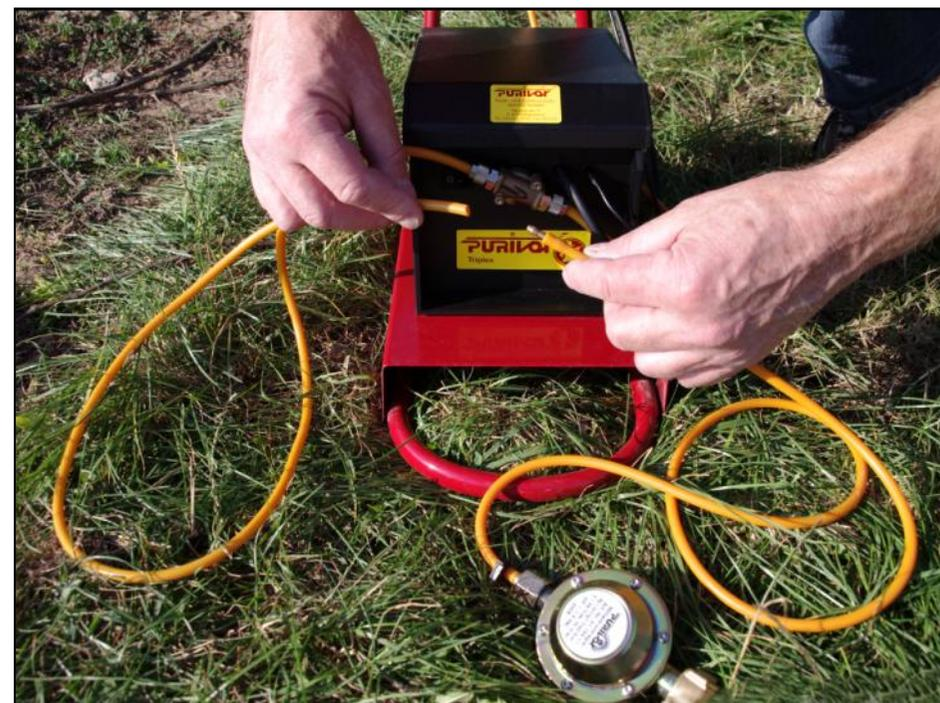
Reliez le tuyau de gaz (GS-1) partant de l'unité électronique (côté électrovanne / bout non pointu de flèche) à l'embout du tuyau de gaz du régulateur KLF (101560).
