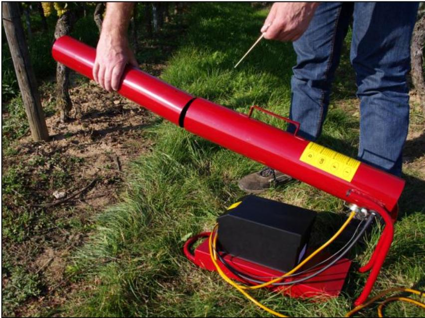
Glissez le tube acoustique dans le support de canon et sécurisez-le avec la goupille d'arrêt (130012). Voir page suivante pour les réglages de tube acoustique.
