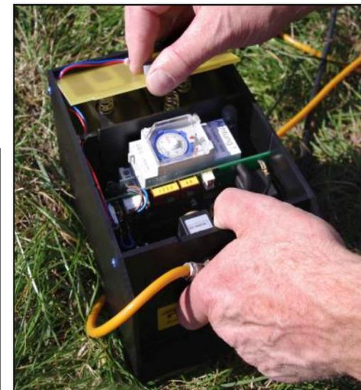
Ouvrez le couvercle de l'unité électronique (108511) et assurez-vous que la bande de papier sous la plaque de contact pour pile a été retirée. Puis, refermez l'unité en appuyant sur la plaque de contact pour pile.
