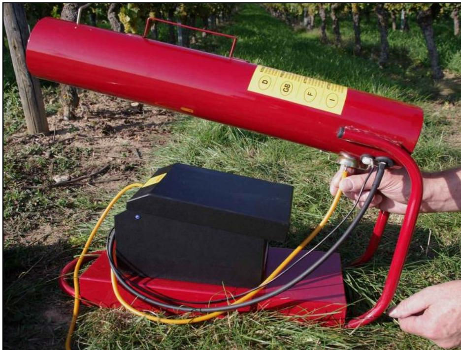
Une fois que la buse de gaz propane a été vissée, connectez le tuyau de gaz sur la buse.
