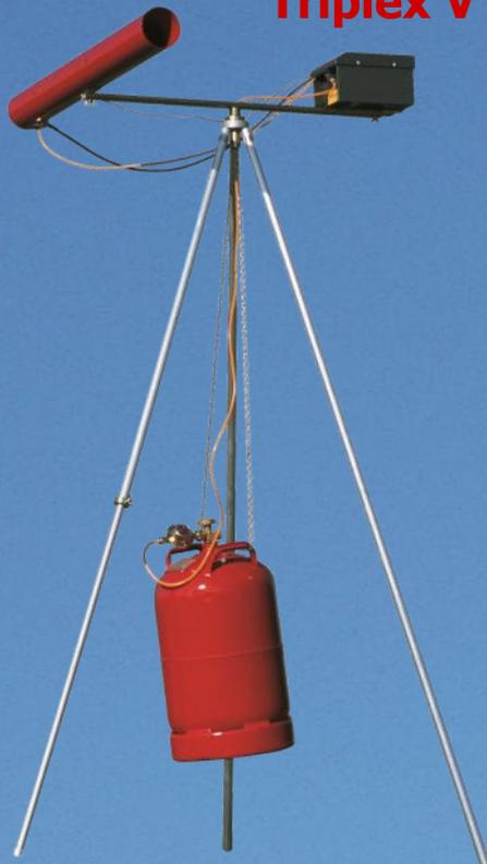
Selbstdrehendes, elektronisches Gas-Knallschreckgerät mit 3-fach Schuss. Durch den Rückstoß des 3-fach Schusses wird eine Drehbewegung verursacht, dadurch hat jeder Schuss eine unterschiedliche Lautstärke was die Schreckwirkung erheblich verbessert. Durch die unterschiedlichen Schussrichtungen wird ein Bereich von 360° um das Gerät herum geschützt.
