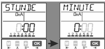
Nach Sonntag drücken Sie noch einmal „OK“. So gelangen Sie zu der Einstellung der Stunden und Minuten, zu welcher Uhrzeit das Gerät schießen soll.
