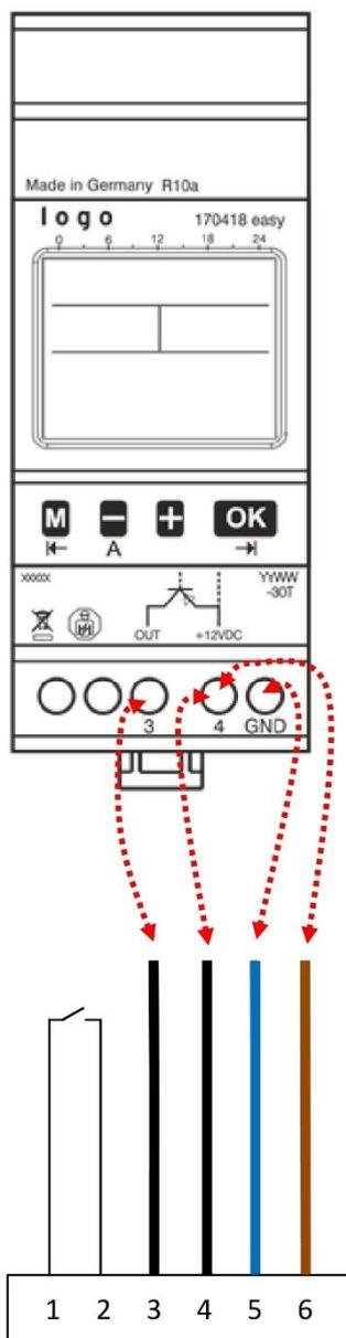
1. Entfernen Sie mithilfe eines kleinen Schraubendrehers die alten Kabel von der eingebaute Schaltuhr
