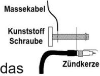
7. Zündkerze durch die Öffnung über dem Gewindeeinsatz einschieben und mit Kunststoffschraube befestigen.
